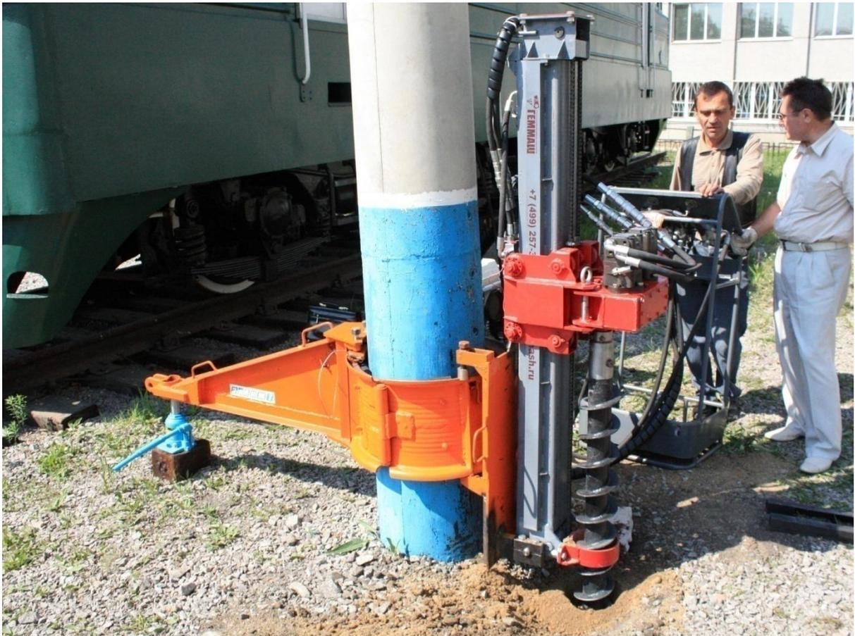
Рис. 1. Установка для выправки опор
