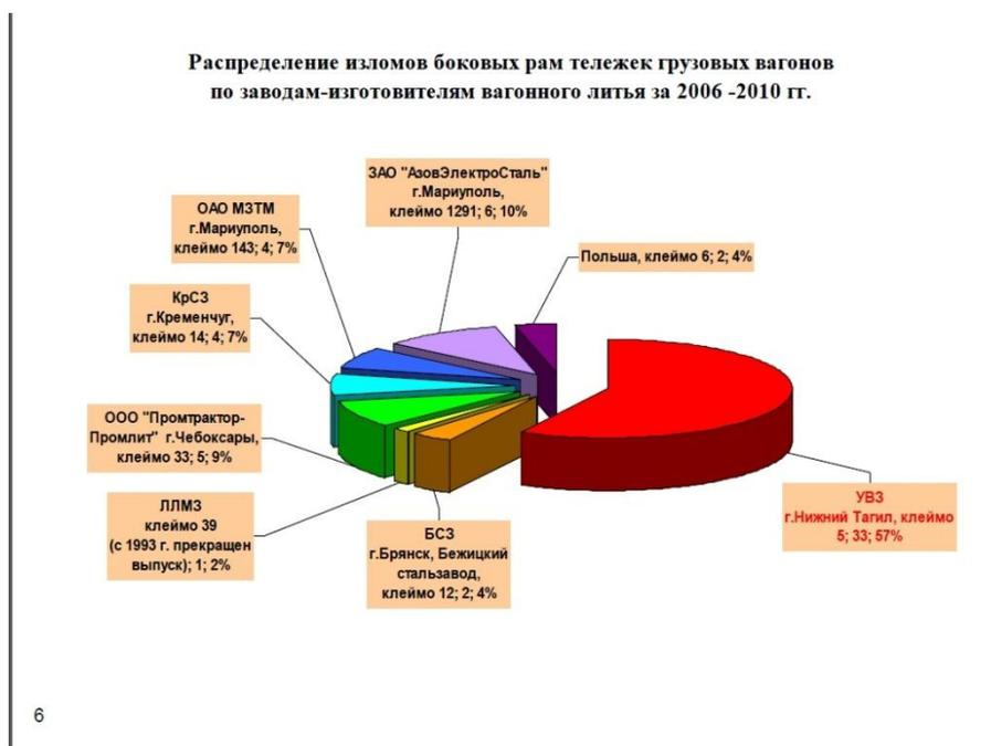
Рис. 3 Распределение изломов боковых рам грузовых вагонов
