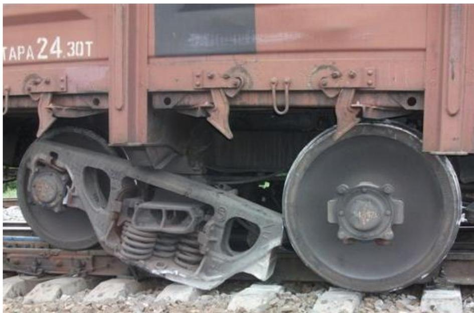
Рис. 1 Излом боковой рамы грузового вагона
