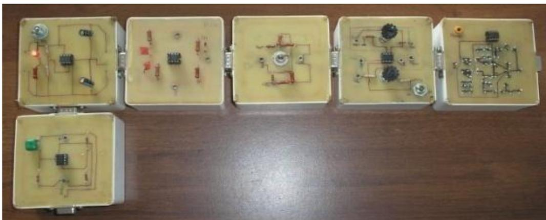
Рис. 1 Общий вид «Модульного конструктора аналоговых схем»
